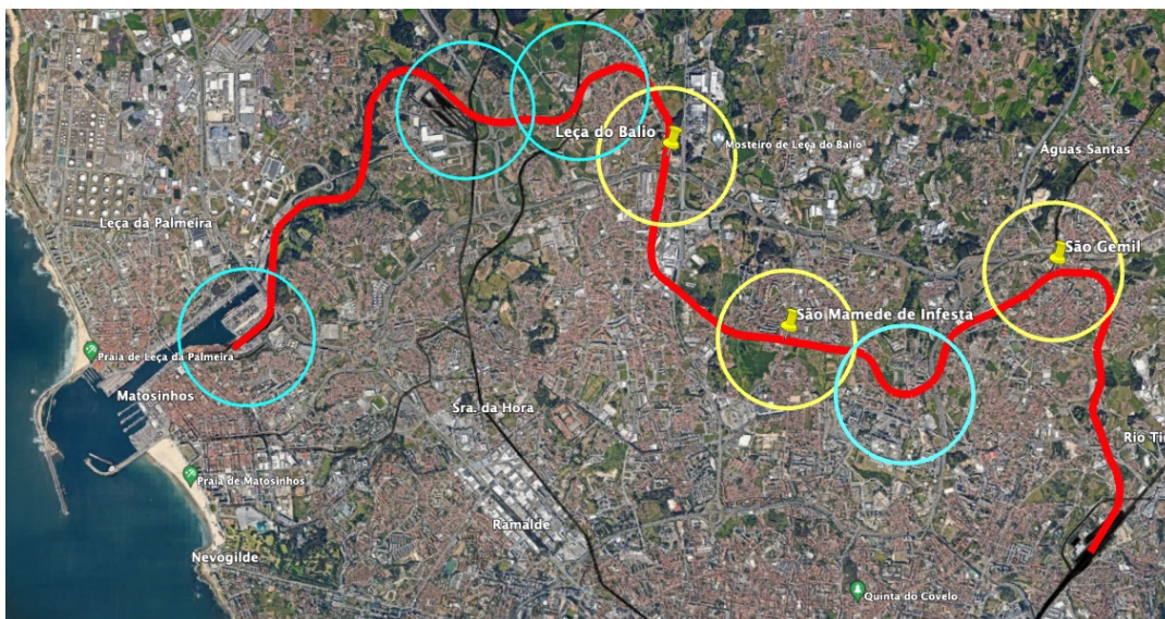
Figura 22. Traçado da Linha de Leixões com raios de 750 m, correspondentes a uma distância a pé de aproximadamente 10 minutos, representados a partir das estações existentes (amarelo) e propostas (azul-claro). As localizações propostas para novas paragens correspondem aos pontos em que a Linha de Leixões intersecta ou se aproxima da rede do Metro do Porto.
